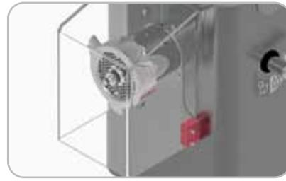
Protezione bocca per piastra con foro Ø > 8 mm
